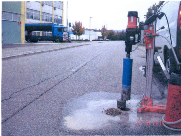
Slika 10: Sondiranje tal, okt. 2016
